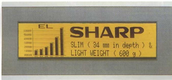
Fig. 7 - Esempio di testi riprodotti dal pannello elettroluminescente LJ640U01. Questo pannello possiede un'area attiva di 60 mm x 192 mm. Il numero di pixel è 640 x 200. È particolarmente adatto alla riproduzione di testi alfanumerici.
