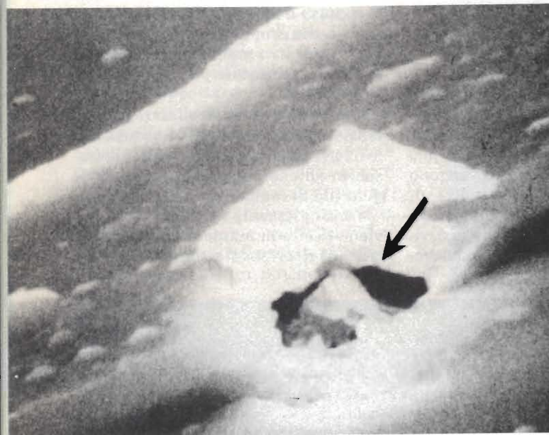
FET-MOS 3N157 (a sinistra) e diodo (a destra) danneggiati irrimediabilmente da cariche elettrostatiche formatesi in un contenitore fatto di materiale isolante.
