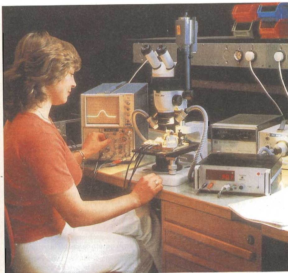
Banco di misura e controllo delle caratteristiche dei dispositivi trasmettitori e ricevitori di luce da fibra ottica prodotti dalla Siemens.
